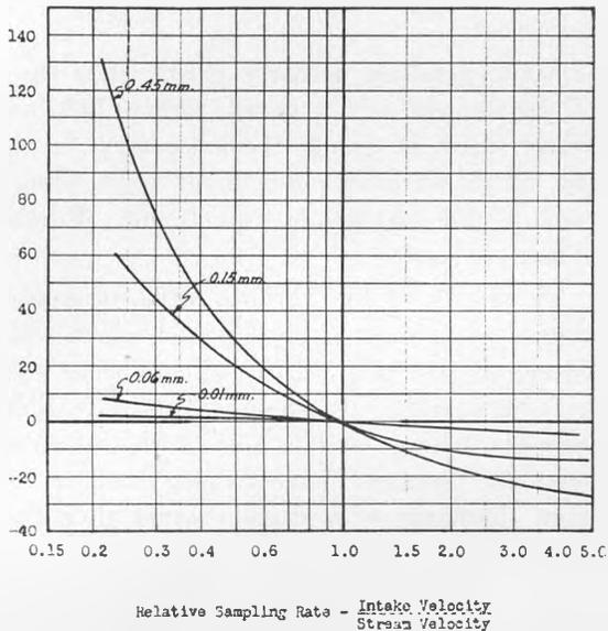
FIG. 5.—ERRORS IN CONCENTRATION RESULTING FROM VARIOUS INTAKE RATES IN TUBE INTAKE.
